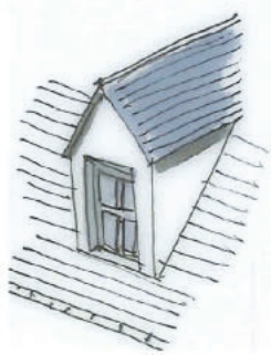
Lucarne dite jacobine à deux pentes (maçonnée et enduite) dite « jacobine » ou « en bâtière »
